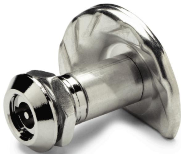
GN119门锁有将近10mm的凸轮拉动范围。顺时针转动旋钮可以锁紧门锁。操作轴心安装了O型圈以防止水侵入。
